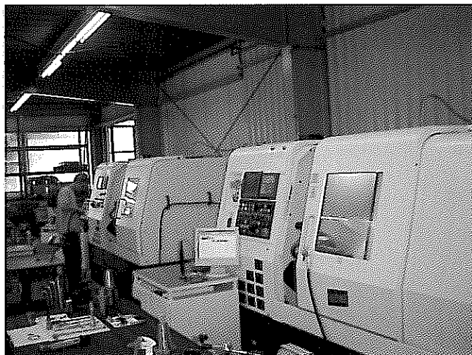
„Die mechanischen Komponenten der Maschinen sind sehr großzügig ausgelegt, die Quest wiegen so beispielsweise 7,5 Tonnen.“
