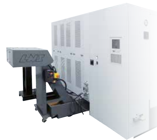
Optionaler Späneförderer an der Maschinenrückseite
